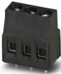
Morsetto per circuiti stampati, corrente nominale: 16 A, tensione di dimensionamento (III/2): 320 V, sezione nominale: 2,5 mm<sup>2</sup>, passo: 5,08 mm, numero poli: 3, collegamento: Connessione a vite con gabbia, montaggio: Saldatura THR, direzione di collegamento conduttore/scheda: 0 °, colore: nero, Layout Pin: Pinning lineare, Lunghezza pin [P]: 3,5 mm. Questo articolo può essere saldato con componenti SMD nel forno reflow.
