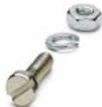
Serie di viti, per il fissaggio della presa base alla parete del dispositivo, comprendente ciascuna una vite M 3 x 10, una rondella elastica e un dado
