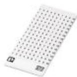
Scheda di siglatura, Scheda, bianco, siglato, longitudinale: numeri progressivi 1 ...10, 11 ...20 ecc. fino a 91 ... (99)100, tipo di montaggio: colla, per morsetti con spessore: 3,81 mm, dimensioni campo di siglatura: 3,81 x 2,8 mm
