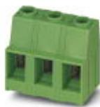
Morsetto per circuiti stampati, corrente nominale: 76 A, tensione di dimensionamento (III/2): 1000 V, sezione nominale: 10 mm<sup>2</sup>, passo: 12,7 mm, numero poli: 3, collegamento: Connessione a vite con gabbia, montaggio: Saldatura ad onde, direzione di collegamento conduttore/scheda: 0 °, colore: verde, Layout Pin: Piedinatura doppia lineare, Lunghezza pin [P]: 5 mm. L'articolo può essere allineato con diversi numeri di poli!
