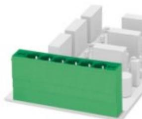
Presi base per circuiti stampati, corrente nominale: 76 A, tensione di dimensionamento (III/2): 1000 V, sezione nominale: 6 mm<sup>2</sup>, numero poli: 7, passo: 10,16 mm, colore: verde, superficie contatti: Argento, montaggio: Saldatura ad onde, layout pin: Pinning lineare, lunghezza pin [P]: 4 mm, La corrente nominale a 76 A è ottenibile in combinazione con connettori della serie PC 16. In combinazione con i connettori PC 6 si raggiungono 41 A (50 A secondo UL).
