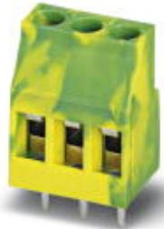
Morsetto per circuiti stampati, sezione nominale: 2,5 mm<sup>2</sup>, passo: 5,08 mm, numero poli: 3, collegamento: Connessione a vite con gabbia, montaggio: Saldatura ad onde, direzione di collegamento conduttore/scheda: 0 °, colore: verde-giallo
