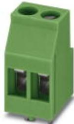
Morsetto per circuiti stampati, sezione nominale: 2,5 mm<sup>2</sup>, passo: 5 mm, numero poli: 6, collegamento: Connessione a vite con gabbia, montaggio: Saldatura ad onde, direzione di collegamento conduttore/scheda: 0 °
