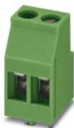
Morsetto per circuiti stampati, sezione nominale: 2,5 mm<sup>2</sup>, passo: 5 mm, numero poli: 2, collegamento: Connessione a vite con gabbia, montaggio: Saldatura ad onde, direzione di collegamento conduttore/scheda: 0°
