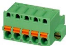
Connettore per circuiti stampati, corrente nominale: 12 A, tensione di dimensionamento (III/2): 320 V, sezione nominale: 2,5 mm<sup>2</sup>, numero poli: 5, passo: 5,08 mm, collegamento: Connessione a molla Push-in, colore: nero, superficie contatti: Stagno
