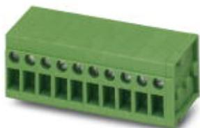
Morsetto per circuiti stampati, corrente nominale: 24 A, tensione di dimensionamento (III/2): 400 V, sezione nominale: 2,5 mm<sup>2</sup>, passo: 5 mm, numero poli: 9, collegamento: Connessione a vite frontale, montaggio: Saldatura ad onde, direzione di collegamento conduttore/scheda: 0 °, colore: nero, Layout Pin: Piedinatura doppia lineare, Lunghezza pin [P]: 3,5 mm. L'articolo può essere allineato con diversi numeri di poli!
