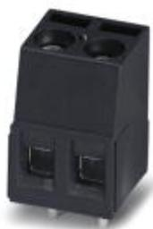
Morsetto per circuiti stampati, corrente nominale: 17,5 A, tensione di dimensionamento (III/2): 400 V, sezione nominale: 1,5 mm<sup>2</sup>, passo: 5,08 mm, numero poli: 3, collegamento: Connessione a vite con gabbia, montaggio: Saldatura ad onde, direzione di collegamento conduttore/scheda: 0 °, colore: nero, Layout Pin: Pinning lineare, Lunghezza pin [P]: 3,5 mm. Connessioni ponticellate internamente
