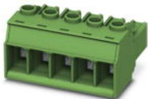
Connettore per circuiti stampati, corrente nominale: 41 A, tensione di dimensionamento (III/2): 1000 V, sezione nominale: 6 mm<sup>2</sup>, numero poli: 5, passo: 7,62 mm, collegamento: Connessione a vite con gabbia, colore: verde, superficie contatti: Stagno
