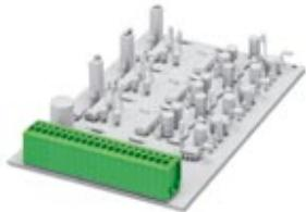
Morsetto per circuiti stampati, corrente nominale: 17,5 A, tensione di dimensionamento (III/2): 320 V, sezione nominale: 1,5 mm<sup>2</sup>, passo: 3,81 mm, numero poli: 3, collegamento: Connessione a vite frontale, montaggio: Saldatura ad onde, direzione di collegamento conduttore/scheda: 90 °, colore: più colori, Layout Pin: Piedinatura doppia lineare, Lunghezza pin [P]: 3,5 mm
