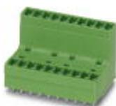
Preso base per circuiti stampati, corrente nominale: 8 A, tensione di dimensionamento (III/2): 160 V, sezione nominale: 1,5 mm<sup>2</sup>, numero poli: 11, passo: 3,81 mm, colore: verde, superficie contatti: Stagno, montaggio: Saldatura ad onde, layout pin: Pinning lineare, lunghezza pin [P]: 3,4 mm, Nel caso della combinazione con i connettori MCV, utilizzare un connettore maschio MCVW e un connettore maschio MCVR.
