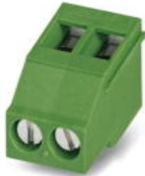
Morsetto per circuiti stampati, corrente nominale: 24 A, tensione di dimensionamento (III/2): 400 V, sezione nominale: 2,5 mm<sup>2</sup>, passo: 5 mm, numero poli: 2, collegamento: Connessione a vite con gabbia, montaggio: Saldatura ad onde, direzione di collegamento conduttore/scheda: 90 °, colore: nero, Layout Pin: Pinning lineare, Lunghezza pin [P]: 4,1 mm. L'articolo può essere allineato con diversi numeri di poli!
