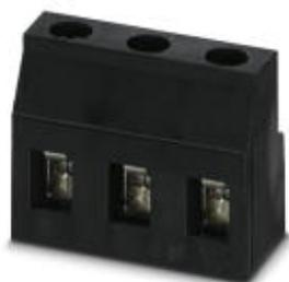
Morsetto per circuiti stampati, sezione nominale: 2,5 mm<sup>2</sup>, passo: 7,5 mm, numero poli: 3, collegamento: Connessione a vite con gabbia, montaggio: Saldatura ad onde, direzione di collegamento conduttore/scheda: 90 °, colore: nero, Layout Pin: Pinning lineare, Lunghezza pin [P]: 4 mm. L'articolo può essere allineato con diversi numeri di poli!
