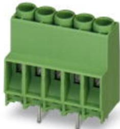
Morsetto per circuiti stampati, sezione nominale: 4 mm<sup>2</sup>, passo: 6,35 mm, numero poli: 4, collegamento: Connessione a vite con gabbia, montaggio: Saldatura ad onde, direzione di collegamento conduttore/scheda: 0 °, colore: verde, Layout Pin: Piedinatura singola mista, Lunghezza pin [P]: 5 mm
