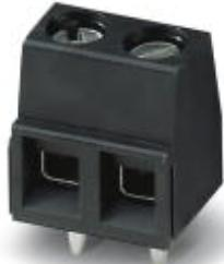
Morsetto per circuiti stampati, corrente nominale: 13,5 A, tensione di dimensionamento (III/2): 320 V, sezione nominale: 1,5 mm<sup>2</sup>, passo: 5,08 mm, numero poli: 2, collegamento: Connessione a vite con gabbia, montaggio: Saldatura THR, direzione di collegamento conduttore/scheda: 0 °, colore: grigio chiaro, Layout Pin: Pinning lineare, Lunghezza pin [P]: 3,5 mm
