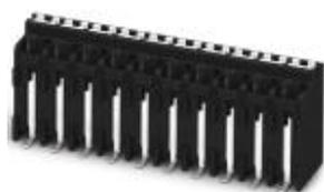
Morsetto per circuiti stampati, corrente nominale: 13,5 A, tensione di dimensionamento (III/2): 160 V, sezione nominale: 1,5 mm<sup>2</sup>, passo: 3,5 mm, numero poli: 11, collegamento: Connessione a molla Push-in, montaggio: Saldatura SMD, direzione di collegamento conduttore/scheda: 90 °, colore: nero, Layout Pin: Geometria pad lineare. Quantità campione disponibile con SAMPLE SPT...
