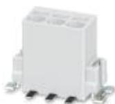
Morsetto per circuiti stampati, corrente nominale: 6 A, tensione di dimensionamento (III/2): 160 V, sezione nominale: 0,5 mm<sup>2</sup>, passo: 2,5 mm, numero poli: 6, collegamento: Connessione a molla Push-in, montaggio: Saldatura SMD, direzione di collegamento conduttore/scheda: 90 °, colore: bianco, Layout Pin: Geometria pad lineare, Lunghezza pin [P]: 2 mm
