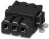
Presa base per circuiti stampati, corrente nominale: 6 A, tensione di dimensionamento (III/2): 160 V, sezione nominale: 0,5 mm<sup>2</sup>, numero poli: 4, passo: 2,5 mm, colore: nero, superficie contatti: Stagno, montaggio: Saldatura SMD, layout pin: Geometria pad lineare, lunghezza pin [P]: 2 mm, Articolo con perno antitorsione
