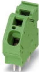
Morsetto per circuiti stampati, corrente nominale: 76 A, tensione di dimensionamento (III/2): 400 V, sezione nominale: 10 mm<sup>2</sup>, passo: 10 mm, numero poli: 3, collegamento: Connessione a molla, montaggio: Saldatura ad onde, direzione di collegamento conduttore/scheda: 45 °, colore: più colori, Layout Pin: Piedinatura 2x2 lineare, Lunghezza pin [P]: 6,5 mm
