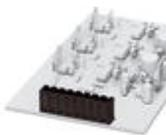
Preso base per circuiti stampati, numero poli: 4, passo: 5,08 mm, colore: nero, superficie contatti: Stagno, layout pin: Pinning lineare, lunghezza pin [P]: 3,9 mm, Le informazioni per l'utente e le proposte di progettazione per la tecnologia Through Hole Reflow sono indicate nella pagina "Download"
