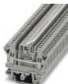
Morsetto passante, tensione nominale: 250 V, corrente nominale: 24 A, collegamento: Connessione a vite, numero di connessioni: 3, numero poli: 1, sezione: 0,2 mm<sup>2</sup> - 4 mm<sup>2</sup>, AWG: 24 - 12, larghezza: 5,08 mm, colore: grigio, tipo di montaggio: NS 32, NS 35/15, NS 35/7,5
