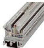
Morsetto passante, tensione nominale: 250 V, corrente nominale: 12 A, collegamento: Connessione a vite, numero di connessioni: 2, numero poli: 1, sezione: 0,2 mm<sup>2</sup> - 4 mm<sup>2</sup>, AWG: 24 - 12, larghezza: 5,08 mm, colore: grigio, tipo di montaggio: NS 32, NS 35/15, NS 35/7,5
