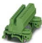
Connettore della guida, corrente nominale: 12 A, tensione di dimensionamento (III/2): 320 V, sezione nominale: 2,5 mm<sup>2</sup>, numero poli: 10, passo: 5,08 mm, collegamento: Connessione a vite con gabbia, colore: verde, superficie contatti: Stagno, montaggio: Guida di supporto
