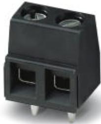
Morsetto per circuiti stampati, corrente nominale: 13,5 A, tensione di dimensionamento (III/2): 320 V, sezione nominale: 1,5 mm<sup>2</sup>, passo: 5,08 mm, numero poli: 2, collegamento: Connessione a vite con gabbia, montaggio: Saldatura THR, direzione di collegamento conduttore/scheda: 0 °, colore: nero, Layout Pin: Pinning lineare, Lunghezza pin [P]: 3,5 mm
