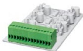
Morsetto per circuiti stampati, corrente nominale: 24 A, tensione di dimensionamento (III/2): 400 V, sezione nominale: 2,5 mm<sup>2</sup>, passo: 5,08 mm, numero poli: 0, collegamento: Connessione a vite con gabbia, montaggio: Saldatura ad onde, direzione di collegamento conduttore/scheda: 0 °, colore: verde, Layout Pin: Piedinatura doppia lineare, Lunghezza pin [P]: 3,5 mm
