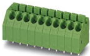
Morsetto per circuiti stampati, corrente nominale: 8 A, tensione di dimensionamento (III/2): 250 V, sezione nominale: 1,5 mm<sup>2</sup>, passo: 3,5 mm, numero poli: 5, collegamento: Connessione a molla Push-in, montaggio: Saldatura ad onde, direzione di collegamento conduttore/scheda: 45 °, colore: più colori, Layout Pin: Piedinatura singola mista, Lunghezza pin [P]: 3,6 mm
