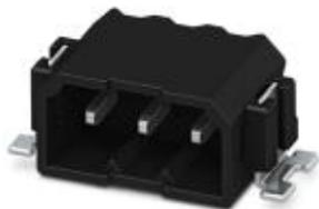
Presi base per circuiti stampati, corrente nominale: 6 A, tensione di dimensionamento (III/2): 160 V, sezione nominale: 0,5 mm<sup>2</sup>, numero poli: 2, passo: 2,5 mm, colore: nero, superficie contatti: Stagno, montaggio: Saldatura SMD, layout pin: Geometria pad lineare, lunghezza pin [P]: 2 mm, Articolo con perno antitorione
