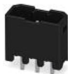
Presse base per circuiti stampati, corrente nominale: 6 A, tensione di dimensionamento (III/2): 160 V, sezione nominale: 0,5 mm<sup>2</sup>, numero poli: 6, passo: 2,5 mm, colore: nero, superficie contatti: Stagno, montaggio: Saldatura THR, layout pin: Pinning lineare, lunghezza pin [P]: 2 mm
