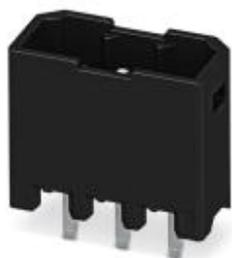
Presse base per circuiti stampati, corrente nominale: 6 A, tensione di dimensionamento (III/2): 160 V, sezione nominale: 0,5 mm<sup>2</sup>, numero poli: 6, passo: 2,5 mm, colore: nero, superficie contatti: Stagno, montaggio: Saldatura THR, layout pin: Pinning lineare, lunghezza pin [P]: 2,1 mm
