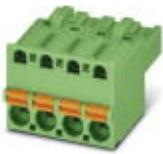
Connettore per circuiti stampati, corrente nominale: 12 A, tensione di dimensionamento (III/2): 320 V, sezione nominale: 2,5 mm<sup>2</sup>, numero poli: 4, passo: 5,08 mm, collegamento: Connessione a molla Push-in, colore: verde, superficie contatti: Stagno
