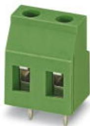
Morsetto per circuiti stampati, corrente nominale: 24 A, tensione di dimensionamento (III/2): 630 V, sezione nominale: 2,5 mm<sup>2</sup>, passo: 7,62 mm, numero poli: 8, collegamento: Connessione a vite con gabbia, montaggio: Saldatura ad onde, direzione di collegamento conduttore/scheda: 0 °, colore: verde, Layout Pin: Pinning lineare, Lunghezza pin [P]: 5 mm. L'articolo può essere allineato con diversi numeri di poli!
