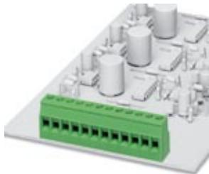
Morsetto per circuiti stampati, corrente nominale: 24 A, tensione di dimensionamento (III/2): 400 V, sezione nominale: 2,5 mm<sup>2</sup>, passo: 5,08 mm, numero poli: 6, collegamento: Connessione a vite con gabbia, montaggio: Saldatura ad onde, direzione di collegamento conduttore/scheda: 0 °, colore: verde, Layout Pin: Piedinatura doppia lineare, Lunghezza pin [P]: 3,7 mm
