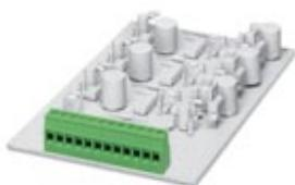
Morsetto per circuiti stampati, corrente nominale: 24 A, tensione di dimensionamento (III/2): 400 V, sezione nominale: 2,5 mm<sup>2</sup>, passo: 5,08 mm, numero poli: 8, collegamento: Connessione a vite con gabbia, montaggio: Saldatura ad onde, direzione di collegamento conduttore/scheda: 0 °, colore: verde, Layout Pin: Pinning lineare, Lunghezza pin [P]: 3,7 mm
