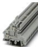
Morsetto a due piani, tensione nominale: 250 V, corrente nominale: 12 A, collegamento: Connessione a vite, numero di connessioni: 4, numero poli: 1, sezione: 0,2 mm<sup>2</sup> - 4 mm<sup>2</sup>, AWG: 24 - 12, larghezza: 5,08 mm, colore: grigio, tipo di montaggio: NS 35/7,5, NS 35/15, NS 32
