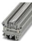
Morsetto passante, tensione nominale: 250 V, corrente nominale: 24 A, collegamento: Connessione a vite, numero di connessioni: 3, numero poli: 1, sezione: 0,2 mm<sup>2</sup> - 4 mm<sup>2</sup>, AWG: 24 - 12, larghezza: 5,08 mm, colore: grigio, tipo di montaggio: NS 32, NS 35/15, NS 35/7,5
