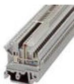
Morsetto passante, tensione nominale: 250 V, corrente nominale: 12 A, collegamento: Connessione a vite, numero di connessioni: 2, numero poli: 1, sezione: 0,2 mm<sup>2</sup> - 4 mm<sup>2</sup>, AWG: 24 - 12, larghezza: 5,08 mm, colore: grigio, tipo di montaggio: NS 32, NS 35/15, NS 35/7,5
