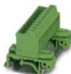
Connettore della guida, corrente nominale: 12 A, tensione di dimensionamento (III/2): 320 V, sezione nominale: 2,5 mm<sup>2</sup>, numero poli: 14, passo: 5,08 mm, collegamento: Connessione a vite con gabbia, colore: verde, superficie contatti: Stagno, montaggio: Guida di supporto
