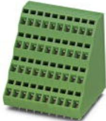
Morsetto per circuiti stampati, corrente nominale: 12 A, tensione di dimensionamento (III/2): 400 V, sezione nominale: 1,5 mm<sup>2</sup>, passo: 5,08 mm, numero poli: 8, collegamento: Connessione a molla, montaggio: Saldatura ad onde, direzione di collegamento conduttore/scheda: 45 °, colore: grigio, Layout Pin: Pinning lineare, Lunghezza pin [P]: 3,4 mm
