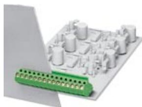
Morsetto per circuiti stampati, corrente nominale: 26 A, tensione di dimensionamento (III/2): 400 V, sezione nominale: 2,5 mm<sup>2</sup>, passo: 5 mm, numero poli: 1, collegamento: Connessione a vite con gabbia, montaggio: Saldatura ad onde, direzione di collegamento conduttore/scheda: 315 °, colore: blu, Layout Pin: Piedinatura doppia lineare, Lunghezza pin [P]: 3,4 mm
