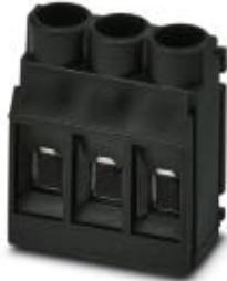
Morsetto per circuiti stampati, corrente nominale: 32 A, tensione di dimensionamento (III/2): 630 V, sezione nominale: 4 mm<sup>2</sup>, passo: 6,35 mm, numero poli: 3, collegamento: Connessione a vite con gabbia, montaggio: Saldatura ad onde, direzione di collegamento conduttore/scheda: 0 °, colore: nero, Layout Pin: Pinning lineare, Lunghezza pin [P]: 3 mm
