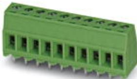
Morsetto per circuiti stampati, corrente nominale: 8 A, tensione di dimensionamento (III/2): 320 V, sezione nominale: 1,5 mm<sup>2</sup>, passo: 3,81 mm, numero poli: 2, collegamento: Connessione a vite con gabbia, montaggio: Saldatura ad onde, direzione di collegamento conduttore/scheda: 0 °, colore: nero, Layout Pin: Piedinatura doppia lineare, Lunghezza pin [P]: 2,7 mm
