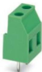
Morsetto per circuiti stampati, corrente nominale: 24 A, tensione di dimensionamento (III/2): 630 V, sezione nominale: 2,5 mm<sup>2</sup>, passo: 7,5 mm, numero poli: 2, collegamento: Connessione a vite con gabbia, montaggio: Saldatura ad onde, direzione di collegamento conduttore/scheda: 0 °, colore: verde, Layout Pin: Pinning lineare, Lunghezza pin [P]: 5 mm. Idonea per moduli vuoti EMG 15
