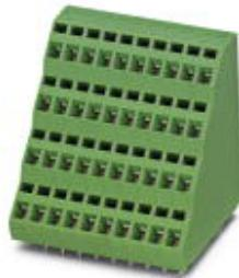
Morsetto per circuiti stampati, corrente nominale: 12 A, tensione di dimensionamento (III/2): 400 V, sezione nominale: 1,5 mm<sup>2</sup>, passo: 5,08 mm, numero poli: 1, collegamento: Connessione a molla, montaggio: Saldatura ad onde, direzione di collegamento conduttore/scheda: 45 °, colore: grigio, Layout Pin: Pinning lineare, Lunghezza pin [P]: 3,4 mm. Morsetto terminale per la chiusura di blocchi affiancati secondo le esigenze individuali.
