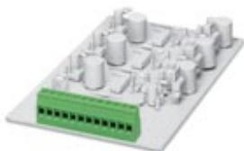
Morsetto per circuiti stampati, corrente nominale: 24 A, tensione di dimensionamento (III/2): 400 V, sezione nominale: 2,5 mm<sup>2</sup>, passo: 5,08 mm, numero poli: 9, collegamento: Connessione a vite con gabbia, montaggio: Saldatura ad onde, direzione di collegamento conduttore/scheda: 0 °, colore: verde, Layout Pin: Pinning lineare, Lunghezza pin [P]: 3,7 mm
