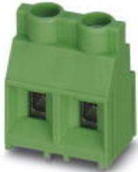
Morsetto per circuiti stampati, corrente nominale: 32 A, tensione di dimensionamento (III/2): 1000 V, sezione nominale: 4 mm<sup>2</sup>, passo: 9,52 mm, numero poli: 3, collegamento: Connessione a vite con gabbia, montaggio: Saldatura ad onde, direzione di collegamento conduttore/scheda: 0 °, colore: verde, Layout Pin: Pinning lineare, Lunghezza pin [P]: 5 mm. L'articolo può essere allineato con diversi numeri di poli!
