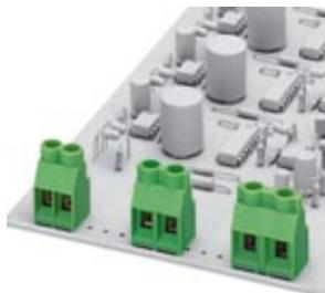
Morsetto per circuiti stampati, corrente nominale: 32 A, tensione di dimensionamento (III/2): 1000 V, sezione nominale: 4 mm<sup>2</sup>, passo: 9,52 mm, numero poli: 2, collegamento: Connessione a vite con gabbia, montaggio: Saldatura ad onde, direzione di collegamento conduttore/scheda: 0 °, colore: nero, Layout Pin: Pinning lineare, Lunghezza pin [P]: 5 mm. L'articolo può essere allineato con diversi numeri di poli!
