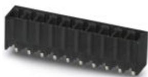
Presale base per circuiti stampati, corrente nominale: 8 A, tensione di dimensionamento (III/2): 160 V, sezione nominale: 1,5 mm<sup>2</sup>, numero poli: 9, passo: 3,81 mm, colore: nero, superficie contatti: Stagno, montaggio: Saldatura THR, layout pin: Pinning lineare, lunghezza pin [P]: 2,6 mm, Le informazioni per l'utente e le proposte di progettazione per la tecnologia Through Hole Reflow sono indicate nella pagina "Download"
