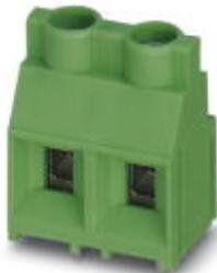
Morsetto per circuiti stampati, corrente nominale: 32 A, tensione di dimensionamento (III/2): 1000 V, sezione nominale: 4 mm<sup>2</sup>, passo: 9,52 mm, numero poli: 2, collegamento: Connessione a vite con gabbia, montaggio: Saldatura ad onde, direzione di collegamento conduttore/scheda: 0 °, colore: grigio, Layout Pin: Pinning lineare, Lunghezza pin [P]: 5 mm
