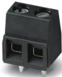
Morsetto per circuiti stampati, corrente nominale: 13,5 A, tensione di dimensionamento (III/2): 320 V, sezione nominale: 1,5 mm<sup>2</sup>, passo: 5,08 mm, numero poli: 2, collegamento: Connessione a vite con gabbia, montaggio: Saldatura THR, direzione di collegamento conduttore/scheda: 0 °, colore: grigio chiaro, Layout Pin: Pinning lineare, Lunghezza pin [P]: 3,5 mm. L'articolo può essere allineato con diversi numeri di poli!
