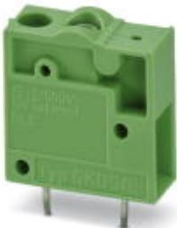
Morsetto per circuiti stampati, corrente nominale: 24 A, tensione di dimensionamento (III/2): 630 V, sezione nominale: 2,5 mm<sup>2</sup>, passo: 7,5 mm, numero poli: 1, collegamento: Connessione a vite con gabbia, montaggio: Saldatura ad onde, direzione di collegamento conduttore/scheda: 0 °, colore: blu, Layout Pin: Piedinatura doppia lineare, Lunghezza pin [P]: 5 mm. L'articolo può essere allineato con diversi numeri di poli!
