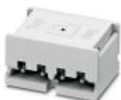
Connettore per circuiti stampati, tensione di dimensionamento (III/2): 25 V, sezione nominale: 0,34 mm<sup>2</sup>, numero poli: 4, passo: 2,4 mm, colore: bianco, superficie contatti: Stagno, montaggio: Connessione diretta, Per circuiti stampati flessibili con una larghezza di 10 mm e uno spessore del circuito stampato ammesso nella zona di contatto di 0,15 mm ... 0,3 mm
