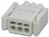
Connettore per circuiti stampati, corrente nominale: 6 A, tensione di dimensionamento (III/2): 160 V, sezione nominale: 0,5 mm<sup>2</sup>, numero poli: 2, passo: 2,5 mm, collegamento: Connessione a molla Push-in, colore: bianco, superficie contatti: Stagno
