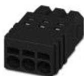
Connettore per circuiti stampati, corrente nominale: 6 A, tensione di dimensionamento (III/2): 160 V, sezione nominale: 0,5 mm<sup>2</sup>, numero poli: 2, passo: 2,5 mm, collegamento: Connessione a molla Push-in, colore: nero, superficie contatti: Stagno
