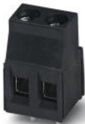
Morsetto per circuiti stampati, corrente nominale: 24 A, tensione di dimensionamento (III/2): 400 V, sezione nominale: 2,5 mm<sup>2</sup>, passo: 5,08 mm, numero poli: 2, collegamento: Connessione a vite con gabbia, montaggio: Saldatura ad onde, direzione di collegamento conduttore/scheda: 0 °, colore: nero, Layout Pin: Pinning lineare, Lunghezza pin [P]: 3,5 mm
