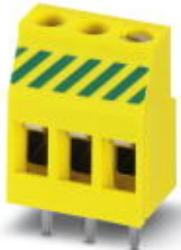
Morsetto per circuiti stampati, corrente nominale: 24 A, tensione di dimensionamento (III/2): 400 V, sezione nominale: 2,5 mm<sup>2</sup>, passo: 5,08 mm, numero poli: 3, collegamento: Connessione a vite con gabbia, montaggio: Saldatura ad onde, direzione di collegamento conduttore/scheda: 0 °, colore: verde-giallo, Layout Pin: Pinning lineare, Lunghezza pin [P]: 5 mm. Connessioni ponticellate internamente
